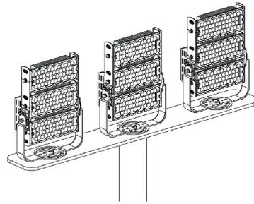
Adapter für vertikale Montage.
